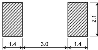
**図 9.1 参考パッド寸法 (Unit: mm)**
