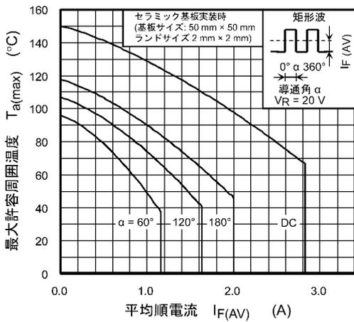
図 10.3  $T_{a(max)} - I_{F(AV)}$
