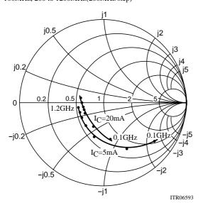
S12e : V<sub>CE</sub>=10V f=100MHz, 200 to 1200MHz(200MHz step)
